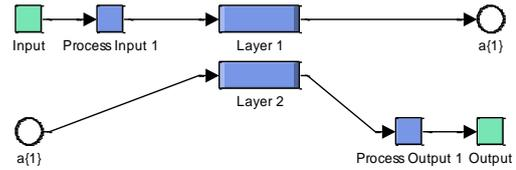
Fig. 4 FNN structure of SVPWM technique.
