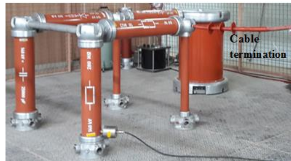
Fig. 6 HV test arrangement.
